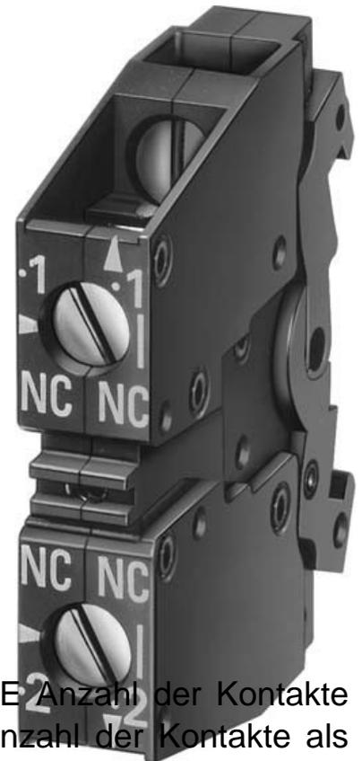
Siemens Indus.Sector Schaltelement 1Ö 1Ö 3SB3400-0E Anzahl der Kontakte als Wechsler 0, Anzahl der Kontakte als Schließer 0, Anzahl der Kontakte als Öffner 2, Bemessungsbetriebsstrom I<sub>e</sub> bei AC-15, 230 V 10A, Ausführung des elektrischen Anschlusses Schraubanschluss, Montageart Frontbefestigung, Betätiger-/Melderkomponente, Schaltelement mit 2 Schaltgliedern, Schraubanschluss
