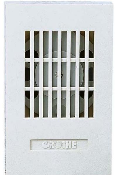
Grothe Läutewerk 85dB 24V weiß LTW 1171A 24V AC Durchmesser Glockenschale 50mm, Gehäusefarbe weiß, Werkstoff des Gehäuses Kunststoff, Lautstärke 85dB, Nennspannung 24V, Schutzart (IP) IP00, Stromart AC, Stromaufnahme 0,17A, Tonart sonstige, Montageart Aufputz, Größe: 99x62x28 mm
