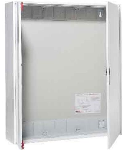
Striebel&John Wandschrank 3/3A Höhe 1100mm, Breite 800mm, Tiefe 215mm, RAL-Nummer 9016, Werkstoff des Gehäuses Stahlblech/Kunststoff, Oberfläche pulverbeschichtet, Schutzart (IP) IP31, Leitungseinführung, Art des Deckels geschlossen, Leerschrank Aufputz und teilversenkte Montage für den Innenbereich IP31, Schutzisoliert mit entsprechenden Ausbausystem.
