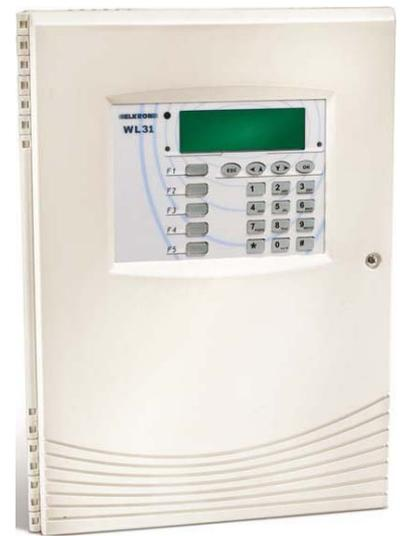
Grothe Funk-Alarmzentrale WL 31 TG Anzahl der Meldegruppen 32, Anzahl der Sabotagegruppen 1, Anzahl der Überfallgruppen 1, Integriertes Wählgerät, Anzahl der Ausgänge für akustische Signalgeber 1, Anzahl der Ausgänge für optische Signalgeber 1, Ereignisspeicher, Betriebsspannung 3,6V, Funkanbindung, VdS Klasse ohne, Höhe 345mm, Breite 245mm, Tiefe 65mm,
