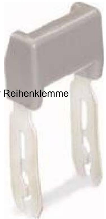
WAGO Kontakttechnik Schachtelbrücker 1 auf 6 780-456 Ausführung Schachtelverbinder, Anzahl der gebrückten Klemmen 2, Explosionsgeprüfte Ausführung Ex e, Bemessungsstrom In 24A, Bemessungsspannung 400V, Isoliert, Mit Berührungsschutz, Montageart steckbar, Rastermaß 5mm, Farbe grau,
