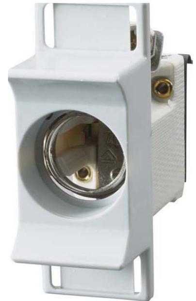
Mersen NEOZED-Sicherungssockel D02,63A,400V,1p 01721.270000 Polzahl 1, Baugröße D02, Werkstoff Porzellan, Ausführung mit Abdeckung, Montageart Schnappbefestigung, Bemessungsspannung 230V, Bemessungsstrom 63A, Sicherungssockel NEOZED mit Berührungsschutzdeckel Größe D02 Bemessungsspannung AC 230/400 V für Tragschienen nach DIN EN 60715 1-polig
