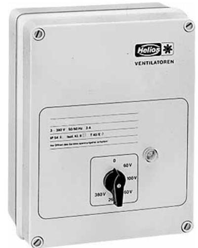
Helios Trafo-Drehzahlsteller mit Motorvollschutzeinri MWS 1,5 Montageart Aufputz, Farbe sonstige, Nennstrom 1,5A, Anzahl der Phasen 1, Anzahl der Stufen 5, Bedienungsart Drehknopf, Beleuchtung Kontrolle (aus), Mit Temperatursensor, Höhe 254mm, Breite 200mm, Tiefe 98mm, Schutzart (IP) IP54, Mit integriertem Auslösegerät für 1-phasen-Lüftermotoren, zum Anschluss von Thermokontakten.
