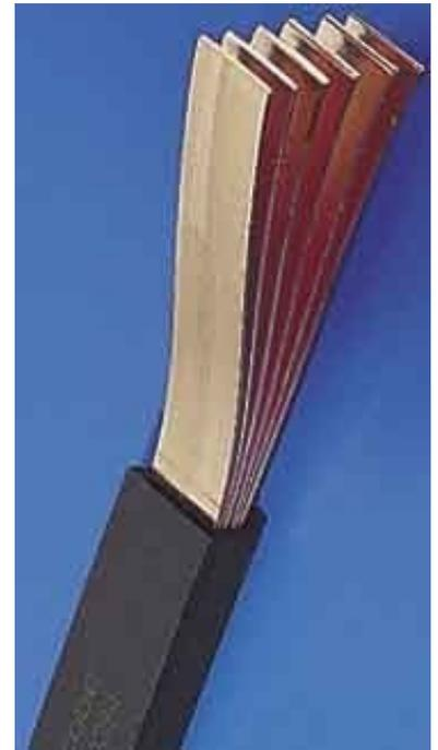
Erico Stromschiene Flexibar 4x32x1 3m Bemessungsbetriebsstrom 500A, Länge 3000mm, Breite 32mm, Stärke 4mm, Lamelliert, Lamellenstärke 1mm, Anzahl der Lamellen 4, Leiter bestehend aus Lamellenpaket, Isolierung aus schwarzer Vinylmasse mit hoher mechanischer Festigkeit.
