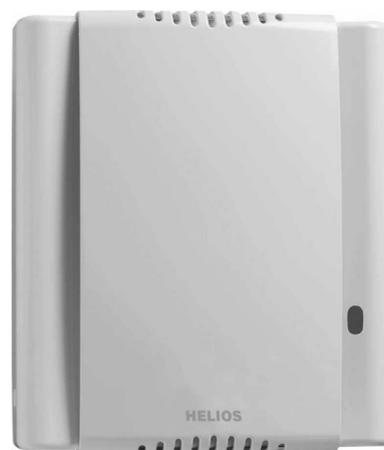
Helios Radialventilator, 1-PH mit 2 Leistungsstufen DX 400 Netzfrequenz 50Hz, Bemessungsspannung 230V, Montageart Aufputz, Werkstoff des Gehäuses Kunststoff, Farbe weiß, Fördervolumen 230m<sup>3</sup>/h, Schutzart (IP) IP44, Nennweite 100mm, Zusammenstellung Standard,
