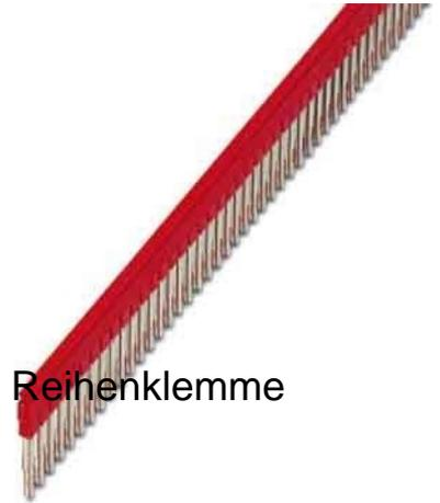
Phoenix Contact Steckbrücke FBS 50-5 Ausführung Querverbinder, Anzahl der gebrückten Klemmen 50, Bemessungsstrom In 24A, Isoliert, Mit Berührungsschutz, Montageart steckbar, Rastermaß 5,2mm, Farbe rot,
