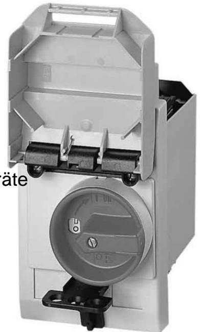
Eaton (Moeller) Isolierstoffgehäuse IP54 E-PKZ0-GR Werkstoff des Gehäuses Kunststoff, Breite 85mm, Höhe 129mm, Tiefe 124mm, Geeignet für NOT-AUS, Ausführung Einbau, Schutzart (IP) IP54, Mit rot-gelbem Drehgriff zur Verwendung als NOT-AUS-Schalter nach EN 60204
