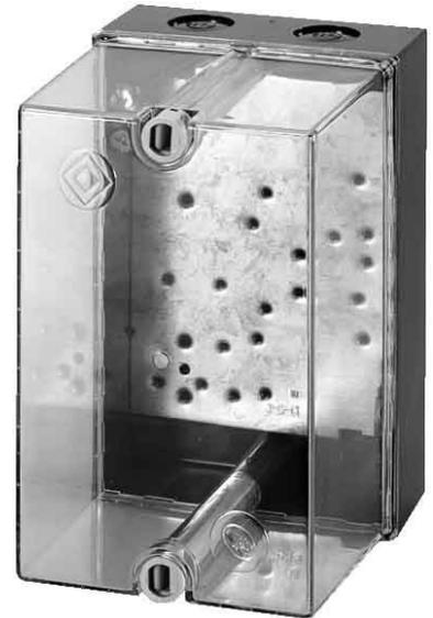
Eaton (Moeller) CI-Kleingehäuse 165x110x128mm CI-C Höhe 165mm, Breite 110mm, Tiefe 128mm, Einbautiefe 110mm, Werkstoff des Gehäuses Kunststoff, Oberfläche ohne, Mit Montageplatte, Schutzart (IP) IP55, Leitungseinführung, Art des Deckels transparent, Leergehäuse, Deckel durchsichtig, metrische Vorprägungen oben und unten, mit PEN-Klemme, Einzelgehäuse IP55 mit Lochplatte
