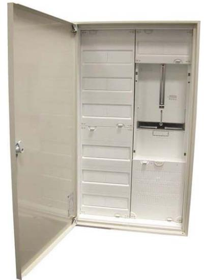
Eaton (Installation) Zählerfeld ZSD-Z39A0576 Ausführung 2-stöckig, Anzahl der Zählerplätze 6, Anzahl der TSG-Plätze 0, Unterer Anschlussraum mit Sammelschiene 5-polig, Montageart Aufputz, Werkstoff Stahlblech, Anzahl der Verteilerreihen 6, Anzahl der Felder 3, Schutzart (IP) IP31, Höhe 1350mm, Breite 750mm, Tiefe 180mm,
