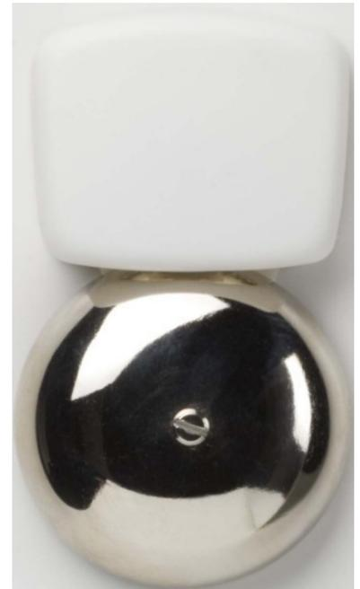
Novar Friedland Lätewerk E2640 Durchmesser Glockenschale 70mm, Gehäusefarbe weiß, Lautstärke 82dB, Nennspannung 8V, Stromart AC, Stromaufnahme 0,7A, Montageart Aufputz, Gehäuse: elfenbeinweiß, Maße: 118x70x30mm
