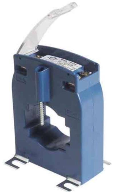
NZR Aufsteckstromwandler K.1 ungeeicht 250/5A 42031440 Ausführung Durchsteckstromwandler, Primärer Bemessungsstrom In 250A, Sekundärer Bemessungsstrom 5A, Sekundäre Bemessungsscheinleistung 5VA, Genauigkeitsklasse 1, Mit Berührungsschutz, Öffnungshöhe 18mm, Öffnungsbreite 30mm, Öffnungsdurchmesser 25mm, Sekundäranschluss Schraubanschluss, Anzahl der Primäreingänge 1, Stromwandler für Niederspannung, Prüfspannung 720 V, Temperaturbereich von -25 bis +55°C, Schutzklasse IP 50
