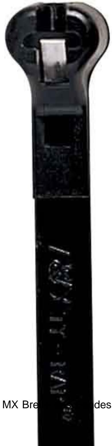
85°C, Ausführung ohne Verzahnung, Bandverschluss Stahlnase, Werkstoff Kunststoff, Werkstoffgüte Polyamid PA, Oberfläche unbehandelt, UV-stabil nach ASTM D6779, Halogenfrei, Farbe schwarz, Beschriftungsfläche ohne, Befestigungsart ohne, MIL-Zulassung, UL-Zulassung, Kabelbinder mit Stahlnasenverschluss, Standard, 771 x 7.6 mm, 540 N, schwarz, PA 6.6 UV-bestaendig, VPE 50
