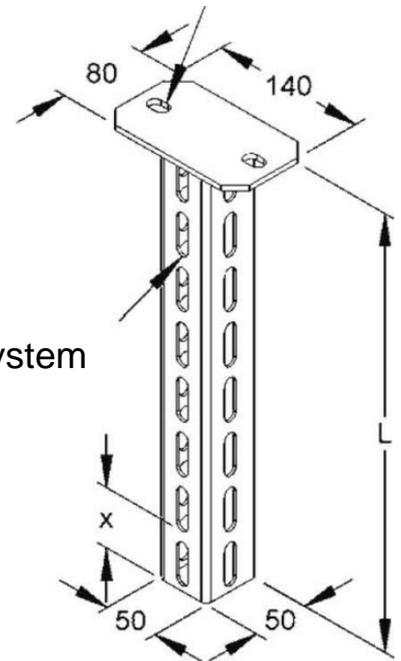
Niedax Hängestiel HU 5050/500 Länge 500mm, Profilbreite 50mm, Profilhöhe 50mm, Ausführung U-Profil, Werkstoff Stahl, Werkstoffgüte sonstige, Oberfläche tauchfeuerverzinkt, Farbe ohne, Hängestiel, mit angeschweißter Kopfplatte und 3-seitig durchgehend perforiertem U-Profil, System HU 5050/..., für Ausleger KTAL..., KTAM..., KTA...
