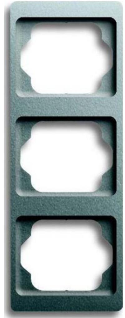
Busch-Jaeger Rahmen 3-fach titan, senkr., alpha 1733 KA-266 Anzahl der Einheiten 3, Montagerichtung vertikal, Anzahl der Module horizontal (bei Modulbauweise) 0, Anzahl der Module vertikal (bei Modulbauweise) 0, Geeignet für Unterputz-Installation, Werkstoff Metall, Werkstoffgüte Aluminium, Halogenfrei, Oberfläche anodisiert/eloxiert, Ausführung der Oberfläche matt, Farbe Titan, Farbvariante Titan, alpha, Rahmen exclusive, Rahmen 3-fach, senkrecht, titan, Abdeckrahmen 3-fach Rahmen Senkrecht.
