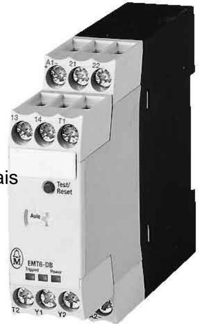
Eaton (Moeller) Motorschutzrelais EMT6-DBK Anzahl der Messkreise 1, Anzahl der Kontakte als Öffner 1, Anzahl der Kontakte als Schließer 1, Anzahl der Kontakte als Wechsler 0, Anschlussart Hilfsstromkreis Schraubanschluss, Externer Reset möglich, Fehlerspeicherung möglich, Bemessungssteuerspeisespannung  $U_s$  24 ...
