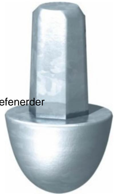
OBO Bettermann Vertr Erderspitze 25mm 1819 25 Ausführung Schlagspitze, Erderdurchmesser 25 mm, Werkstoff Temperguss, Oberfläche unbehandelt, Geeignet für Aufnahmesystem sonstige, DIN 48852 Form Sp, Geeignet für System OMEX
