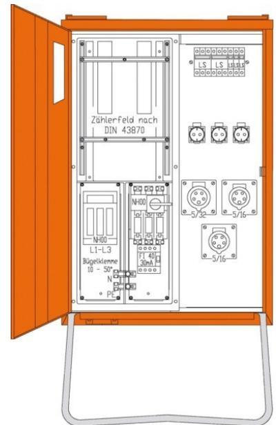
Walther Werke Anschlussverteiler 24kVA 1 Zählerplatz WAV0100 Ausführung Anschlussverteilerschrank, Bemessungsstrom 63A, Anschlussleistung 24kVA,
