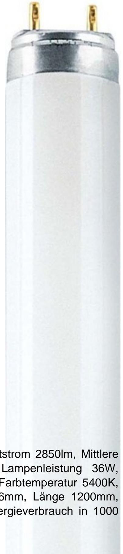
Osram Lumilux-DeLuxe Lampe 36W cws L 36/954 Lichtstrom 2850lm, Mittlere Nennlebensdauer 20000h, Energieeffizienzklasse A, Lampenleistung 36W, Sockel G13, Farbwiedergabestufe 90-100 (Klasse 1A), Farbtemperatur 5400K, Lampenform Stab, Lichtfarbe 954, Rohrdurchmesser 26mm, Länge 1200mm, Farbe sonstige, Anwendung allgemein, Gewichteter Energieverbrauch in 1000
