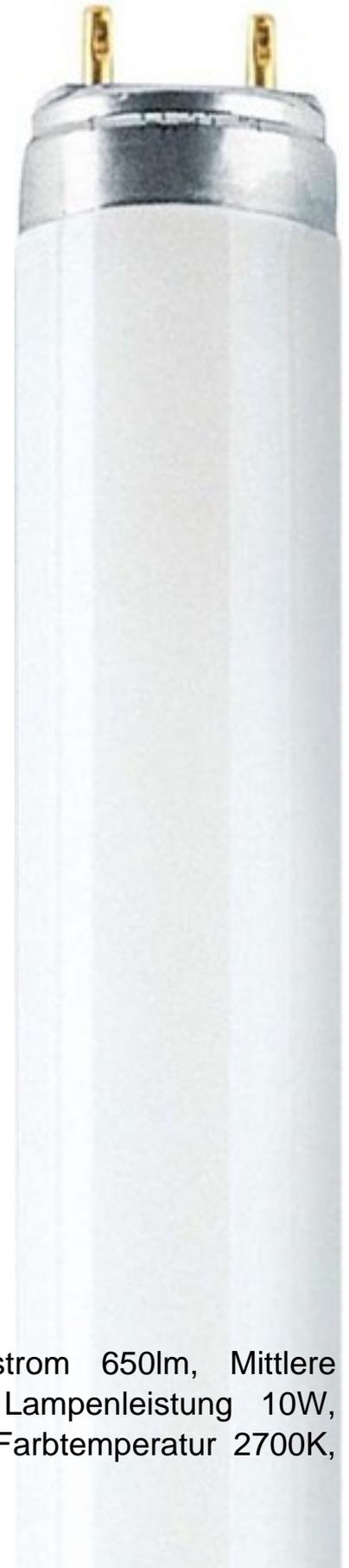
Osram Lumilux-Lampe 10W wws L 10/827 Lichtstrom 650lm, Mittlere Nennlebensdauer 20000h, Energieeffizienzklasse A, Lampenleistung 10W, Sockel G13, Farbwiedergabestufe 80-89 (Klasse 1B), Farbtemperatur 2700K,
