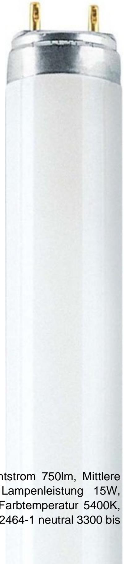
Osram Lumilux-DeLuxe Lampe 15W cws L 15/954 Lichtstrom 750lm, Mittlere Nennlebensdauer 20000h, Energieeffizienzklasse B, Lampenleistung 15W, Sockel G13, Farbwiedergabestufe 90-100 (Klasse 1A), Farbtemperatur 5400K, Lampenform Stab, Lichtfarbe 954, Lichtfarbe gemäß EN 12464-1 neutral 3300 bis
