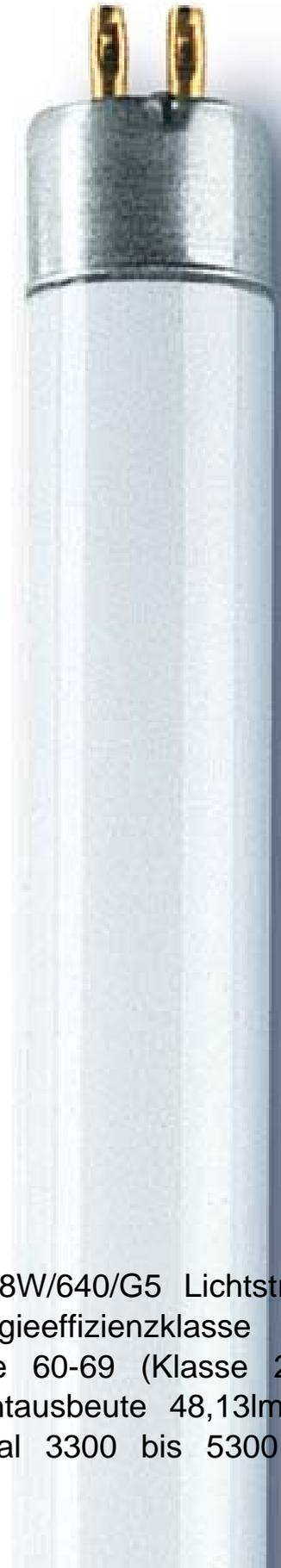
Radium Lampenwerk Leuchtstofflampe hellws NL-T5 8W/640/G5 Lichtstrom 385lm, Mittlere Nennlebensdauer 7000h, Energieeffizienzklasse A, Lampenleistung 8W, Sockel G5, Farbwiedergabestufe 60-69 (Klasse 2B), Farbtemperatur 4300K, Lampenform Stab, Lampenlichtausbeute 48,13lm/W, Lichtfarbe 640, Lichtfarbe gemäß EN 12464-1 neutral 3300 bis 5300 K,
