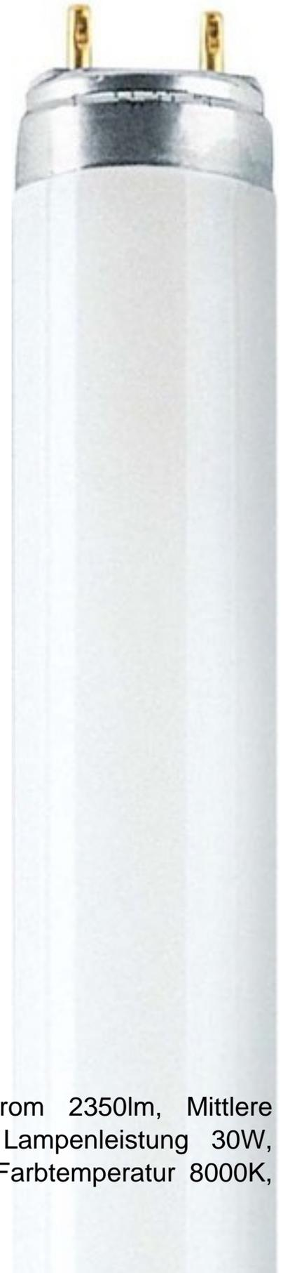
Osram Lumilux-Lampe 30W cws L 30/880 Lichtstrom 2350lm, Mittlere Nennlebensdauer 20000h, Energieeffizienzklasse A, Lampenleistung 30W, Sockel G13, Farbwiedergabestufe 80-89 (Klasse 1B), Farbtemperatur 8000K,
