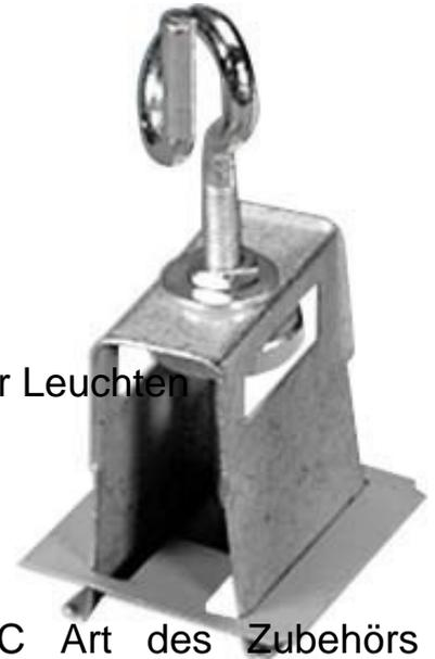
Siteco Kettenabhänger st-vz hoch 20kg 5LJ90910XC Art des Zubehörs Kettenabhängung, Werkstoff Stahl, Ketten-Abhänger \"E\", schienenseitig, Sicherheitshaken mit Höhenausgleich, Stahl verzinkt, ohne Kette, Tragkraft 20 kg
