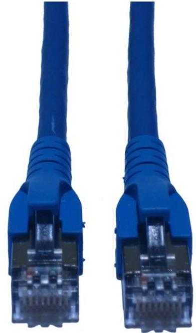
CommScope/AMP Netconn Patchkabel Kat.6A S/FTP RJ45/RJ45, blau TN-6000A bl 0,5m Kabeltyp S/FTP, Kategorie 6A (IEC), Länge 0,5m, Steckverbindertyp Anschluss 1 RJ45 8(8), Steckverbindertyp Anschluss 2 RJ45 8(8), Mantel-Farbe blau, Knickschutztülle angespritzt, Rasthebelschutz, Farbe der Knickschutztülle blau, Ausführung flammwidrig, Halogenfrei, Kabelkonstruktion 4x2, AWG-Querschnitt 27, Pinbelegung 1:1, Die Kat.
