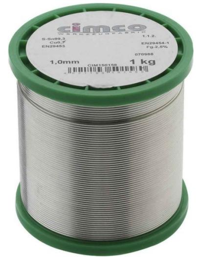
Cimco Elektroniklot bleifrei 1,5mm/100g 15 0162 Durchmesser 1,5mm, Gewicht 100g, Ausführung mit Flussmittel, Flussmittelanteil 2,5%, Nach DIN 29453, S-Sn 99,3 Cu 0,7, mit aktivem Harz-Flußmittel nach DIN EN 29454-1 1.1.2.B 2,5% (Gewicht % 2,5 +0,5), nicht korrosiv auf NE-Metallen, auf Einwegspulen
