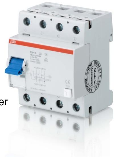
ABB Stotz S&J FI-Schalter F204B-125/0,3L Polzahl 4, Bemessungsspannung 400V, Bemessungsstrom 125A, Bemessungsfehlerstrom 0,3A, Montageart DIN-Schiene, Fehlerstrom-Typ B, Kurzschlussfestigkeit (Icw) 10kA, Stoßstromfestigkeit 3kA, Frequenz 50 Hz, Zusatzeinrichtungen möglich, Schutzart (IP) IP20, Baugröße (nach DIN 43880) 1, Breite in Teilungseinheiten 4, Einbautiefe 75,5mm,
