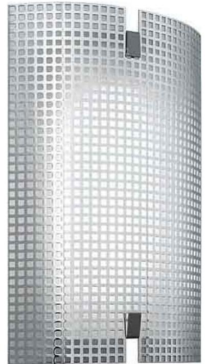
weiß, Lichtaustritt indirekt, Breite 85mm, Höhe 205mm, Tiefe 330mm, Schutzklasse I, Schutzart (IP) IP20, Brandschutz "F", Metallblende perforiert mit Miniquadraten, Reflektorblech, Gehäuse aus Stahlblech, mit hinterlegter Folie aus Polycarbonat mit Samtstruktur (max.
