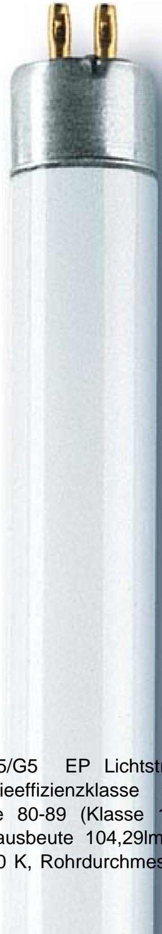
Radium Lampenwerk Leuchtstofflampe NL-T5 35W/865/G5 EP Lichtstrom 3050lm, Mittlere Nennlebensdauer 24000h, Energieeffizienzklasse A+, Lampenleistung 35W, Sockel G5, Farbwiedergabestufe 80-89 (Klasse 1B), Farbtemperatur 6500K, Lampenform Stab, Lampenlichtausbeute 104,29lm/W, Lichtfarbe 865, Lichtfarbe gemäß EN 12464-1 kühl >5300 K, Rohrdurchmesser
