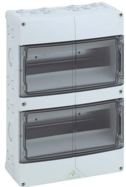
Spelsberg Automatenkasten IP 65 AK 24 Montageart Aufbau, Anzahl der Reihen 2, Breite in Teilungseinheiten 12, Ausführung Deckel mit Ausschnitt, Transparenter Deckel/Tür, Werkstoff des Gehäuses Kunststoff, Höhe 370mm, Breite 250mm, Tiefe 122mm, DIN-Schiene, Farbe grau, RAL-Nummer 7035, Schutzart (IP) IP65, IP65-Kleinverteiler nach DIN 43871/VDE 0603 aus schlagfestem Kunststoff.
