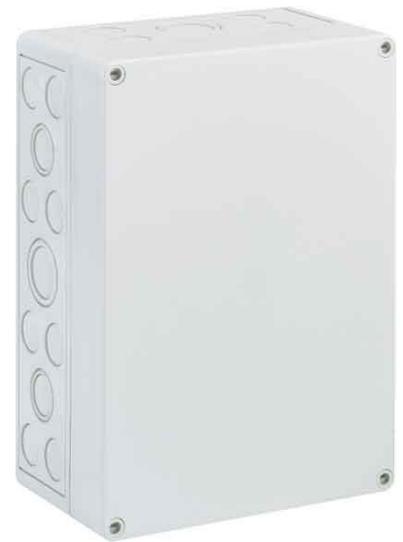
Spelsberg Leergehäuse IP68 TK PS 2518-11-m Höhe 254mm, Breite 180mm, Tiefe 111mm, Einbautiefe 97mm, RAL-Nummer 7035, Werkstoff des Gehäuses Kunststoff, Schutzart (IP) IP66, Leitungseinführung, Art des Deckels geschlossen,
