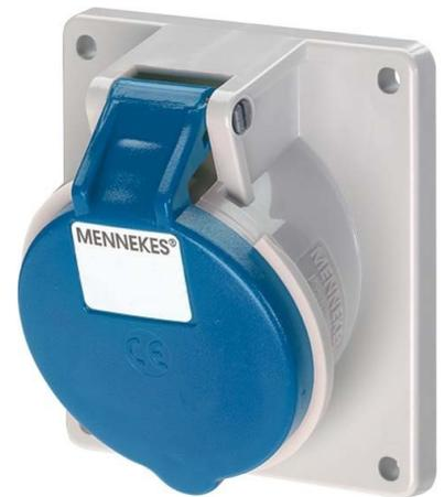
Mennekes Anbaudose TwinContact 16A,3p,6h,230V,IP44 1632 IEC-Stromstärke 16A, Polzahl 3, Spannung nach EN 60309-2 230 V (50+60 Hz) blau, Uhrzeit-Stellung 6h, Kennfarbe blau, Schutzart (IP) IP44, Anschlusstechnik schraublose Klemme, Steckrichtung abgewinkelt, Werkstoff Kunststoff, Flanschmaß vertikal 73,5mm, Bohrlochabstand vertikal 60mm, Flanschmaß horizontal 64mm, Bohrlochabstand horizontal 52mm, Zum Durchverdrahten geeignet, Neigung 20°
