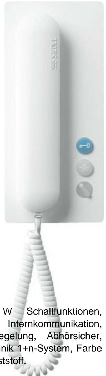
Siedle&Söhne Haustelefon weiss HTS 811-0 W Schaltfunktionen, Funktions-Lampen, Rufabschaltung, Videosteuerung, Internkommunikation, Rufunterscheidung, Montageart Aufputz, Lautstärkeregelung, Abhörsicher, Licht-/Türöffnertaste, Türöffnerautomatik, Installationstechnik 1+n-System, Farbe weiß, Haustelefon Standard für die 1+n-Technik aus Kunststoff.
