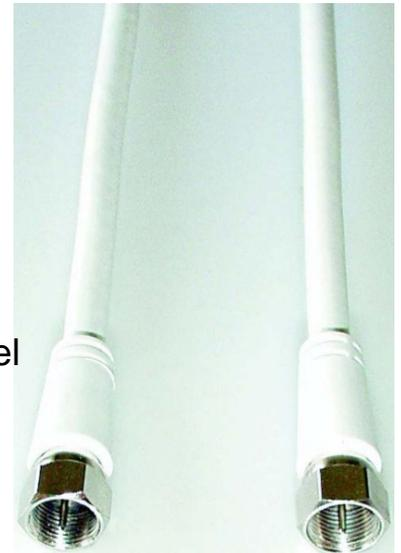
E+P Elektrik F-Anschlußkabel FA25Lose Kabeltyp Antennenkabel, Länge 2,5m, Impedanz 75Ohm, Farbe weiß, Ausführung Anschluss 1 Stecker, Steckverbindertyp Anschluss 1 F, Ausführung Anschluss 2 Stecker, Steckverbindertyp Anschluss 2 F, Abschirmung doppelt geschirmt, Schirmungsmaß >85dB, schraubbar
