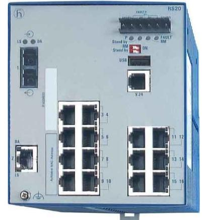
Hirschmann INET Ind.Ethernet Switch RS20-1600L2T1SDAU Ethernet, Anzahl der 10/100 Mbps RJ45-Ports 15, Anzahl der 100 Mbps SC-Ports 1, Anzahl der sonstigen Ports 0, Montageart Hutschiene, Layer 2, Höhe 131mm, Breite 110mm, Tiefe 111mm,
