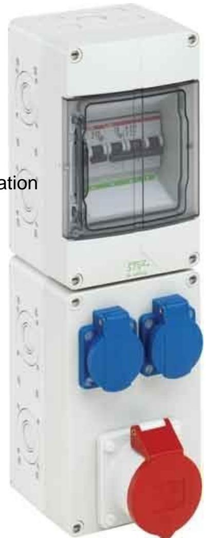
Spelsberg CEE-Steckdosen-Kombination STV 512-K CEE-Steckdose - 16 A 1x16A5p400V, CEE-Steckdose - 32 A ohne, CEE-Steckdose - 63 A ohne, CEE-Steckdose - 125A ohne, Anzahl der SCHUKO-Steckdosen 2, Sonstige Einbauten und/oder Leerplätze 0, Absicherung LS-Schalter, FI-Schutzschalter ohne, Werkstoff des Gehäuses Kunststoff, Einspeisung/Anschlussmöglichkeit 2 Leitungen (Ringleitung/zum Durchschleifen), Handhabung Wandmontage, Schutzart (IP) IP44, Farbe grau,
