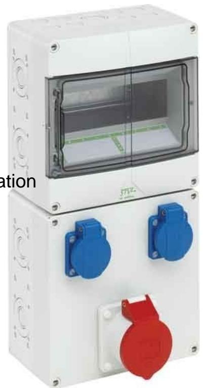
Spelsberg CEE-Steckdosen-Kombination STV 912-S CEE-Steckdose - 16 A 1x16A5p400V, CEE-Steckdose - 32 A ohne, CEE-Steckdose - 63 A ohne, CEE-Steckdose - 125A ohne, Anzahl der SCHUKO-Steckdosen 2, Absicherung ohne, FI-Schutzschalter ohne, Werkstoff des Gehäuses Kunststoff, Einspeisung/Anschlussmöglichkeit 2 Leitungen (Ringleitung/zum Durchschleifen), Handhabung Wandmontage, Schutzart (IP) IP44,
