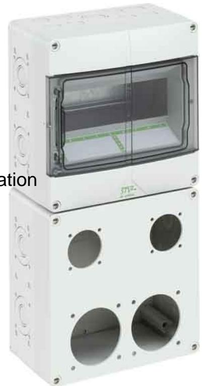
Spelsberg CEE-Steckdosen-Kombination STV 922-L CEE-Steckdose - 16 A ohne, CEE-Steckdose - 32 A ohne, CEE-Steckdose - 63 A ohne, CEE-Steckdose - 125A ohne, Sonstige Einbauten und/oder Leerplätze 4, Absicherung ohne, FI-Schutzschalter ohne, Werkstoff des Gehäuses Kunststoff, Einspeisung/Anschlussmöglichkeit 2 Leitungen (Ringleitung/zum Durchschleifen), Handhabung Wandmontage, Schutzart (IP) IP44,
