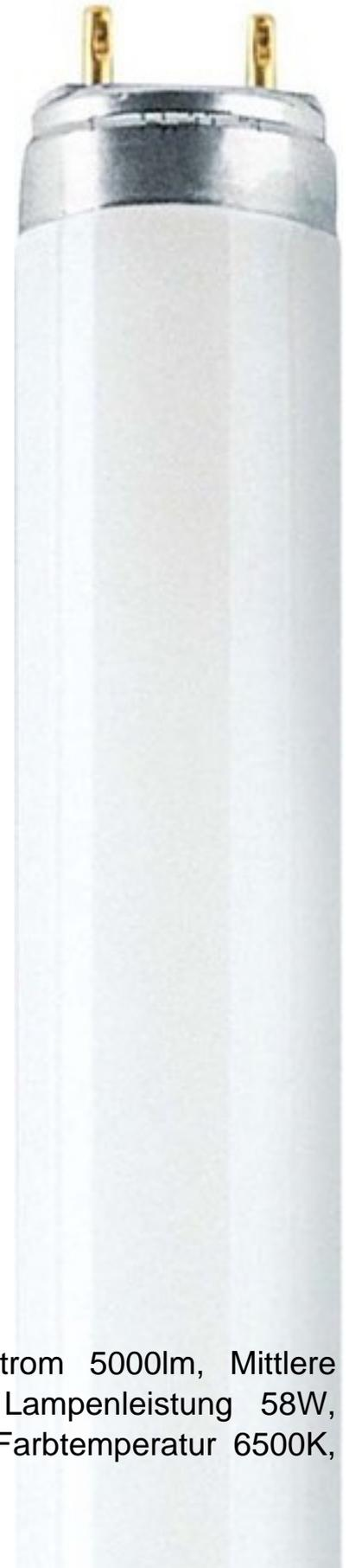
Osram Lumilux-Lampe 58W 6500K L 58/865 Lichtstrom 5000lm, Mittlere Nennlebensdauer 20000h, Energieeffizienzklasse A, Lampenleistung 58W, Sockel G13, Farbwiedergabestufe 80-89 (Klasse 1B), Farbtemperatur 6500K,
