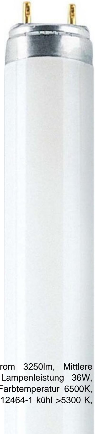
Osram Lumilux-Lampe 36W cws L 36/865 Lichtstrom 3250lm, Mittlere Nennlebensdauer 20000h, Energieeffizienzklasse A, Lampenleistung 36W, Sockel G13, Farbwiedergabestufe 80-89 (Klasse 1B), Farbtemperatur 6500K, Lampenform Stab, Lichtfarbe 865, Lichtfarbe gemäß EN 12464-1 kühl >5300 K,
