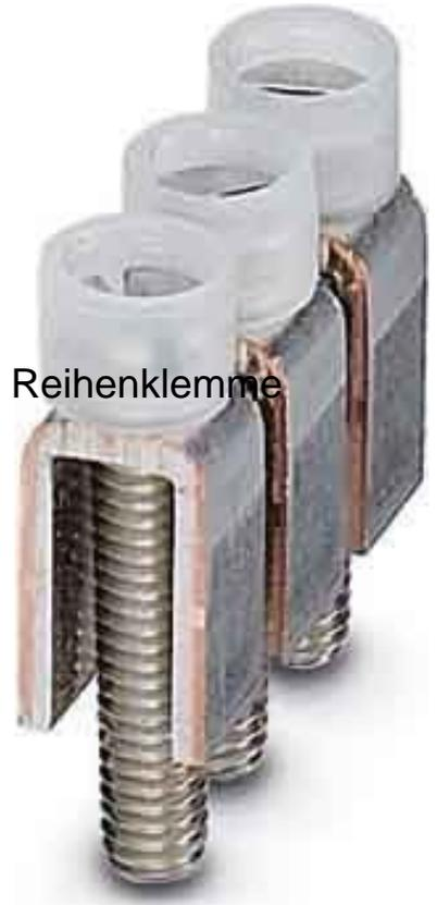
Phoenix Contact Querverbinder/Brücke Polzahl: 3, alu FBI 3- 6 Ausführung Querverbinder, Anzahl der gebrückten Klemmen 3, Bemessungsstrom In 41A, Bemessungsspannung 800V, Isoliert, Mit Berührungsschutz, Montageart schraubbar, Rastermaß 6mm, Farbe sonstige, Zum Querbrücken in Klemmenmitte.
