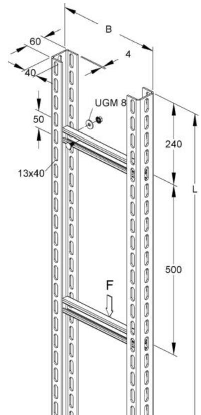
Niedax Steigetrasse STUC 60/1005 E3 Steigetrassenhöhe 60mm, Steigetrassenbreite 1015mm, Länge 4500mm, Seitenlochung, Sprossenabstand 500mm, Ausführung der Sprosse Profil gelocht, Ausführung der Seitenwand U-Profil, Werkstoff sonstige, Werkstoffgüte rostfreier Stahl, Oberfläche sonstige, Farbe ohne, Mittlerer Lochabstand der dreiseitigen Lochung 13x40 mm beträgt 50 mm.
