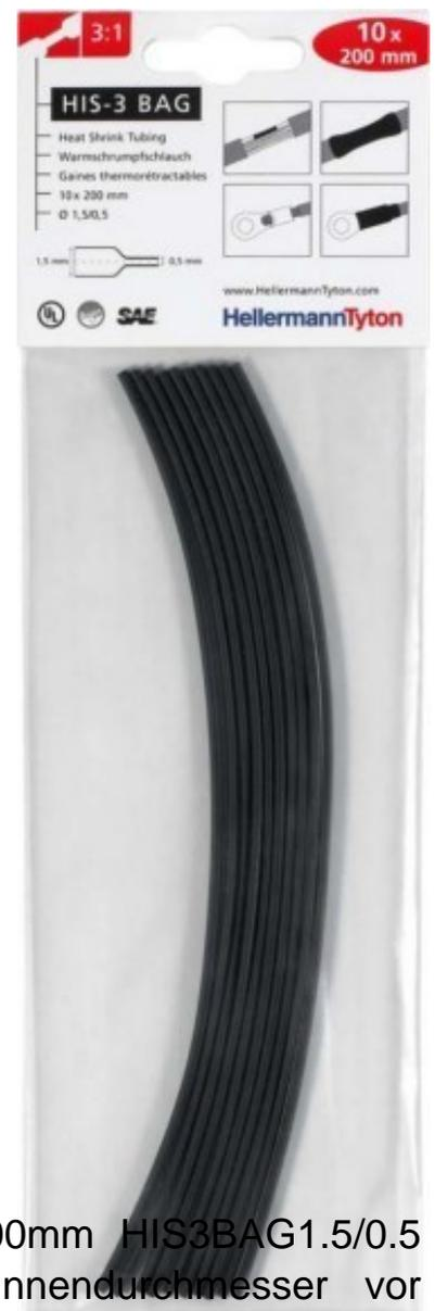
HellermannTyton Schrumpfschlauch 10Abschnitte a 200mm HIS3BAG1.5/0.5 gn-ge Ausführung dünnwandig, Schrumpfrate 3:1, Innendurchmesser vor Schrumpf 1,5mm, Innendurchmesser nach Schrumpf 0,5mm, Nennendurchmesser in Zoll sonstige, Wandstärke nach Schrumpf 0,45mm, Länge 0,2m, Betriebstemperatur -55 ...
