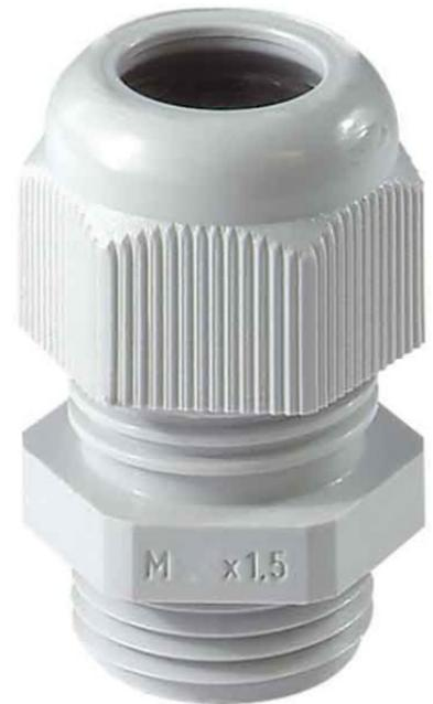
Jacob Kabelverschraubung M32x1,5 50.632 PA 7035 Gewindeart metrisch, Gewindenenngröße metrisch/PG 32, Gewindesteigung 1,5mm, Gewindelänge 10mm, Schlüsselweite 36mm, Für Kabeldurchmesser 15 ...
