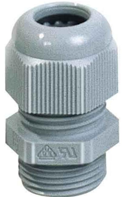
Jacob Kabelverschraubung PA M50x1,5 50.650 PA 7001 Gewindeart metrisch, Gewindenenngröße metrisch/PG 50, Gewindesteigung 1,5mm, Gewindelänge 12mm, Schlüsselweite 55mm, Für Kabeldurchmesser 27 ...
