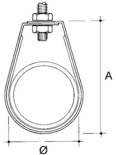
Niedax Rohrbefestigung PH-20 Geeignet für Rohrdurchmesser 20 ...
