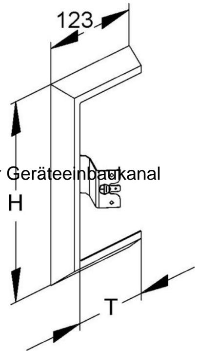
Nidax Wandrosette rechts DWRR 170T100 L Breite 170mm, Tiefe 100mm, Ausführung asymmetrisch, Montageart des Kanals Wand, Werkstoff Stahl, Werkstoffgüte sonstige, Oberfläche beschichtet, Farbe lichtgrau, RAL-Nummer 7035,
